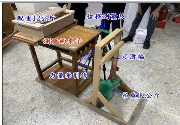
圖 2 側向拉力位移實驗器
