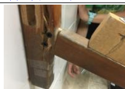
圖 4-16 側向螺絲破壞實驗
