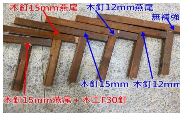
圖 6-5 自製木釘補強結構圖 2
