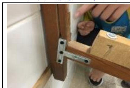
圖 4-14 T 型單面破壞實驗
