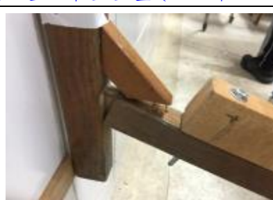
圖 4-15 斜撐單面破壞實驗
