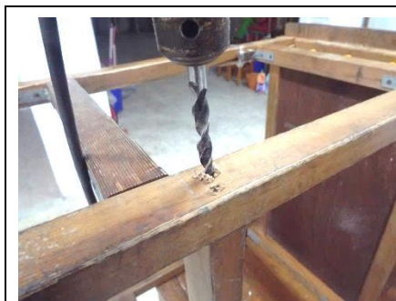
圖 5-8 先補強長度 20mm (C6D6)
