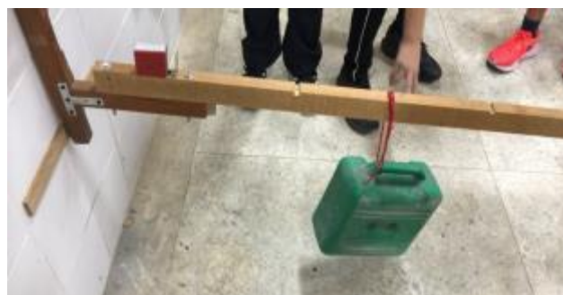
圖 7 破壞強度實驗設備吊重 12 公斤
