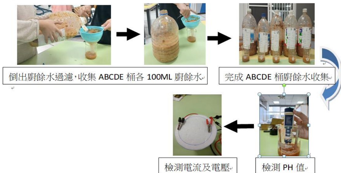
圖4-2 蔬菜廚餘桶及水果廚餘桶測試電流、電壓及PH值流程圖
