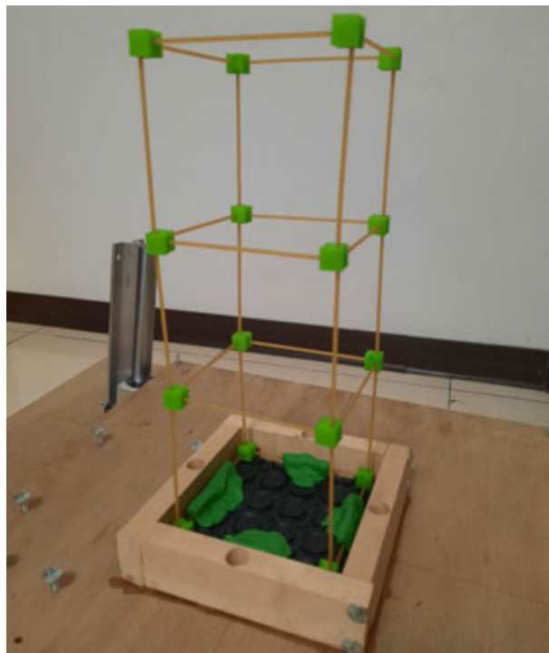
圖3-2-0 所有實驗之不加裝任何抗、制、免震裝置房屋
