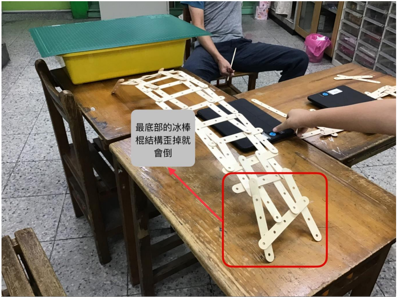
圖5橋容易倒塌的原因
