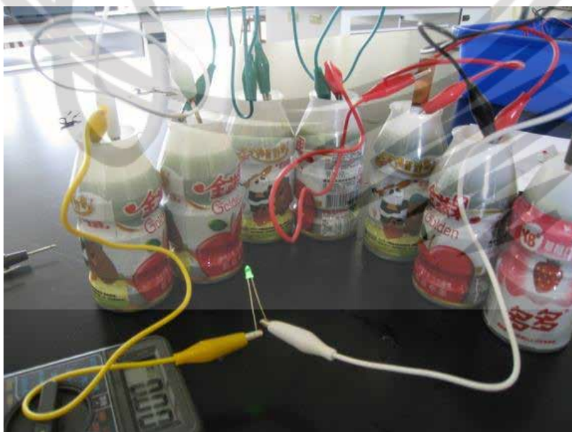
圖五：月桃葉電池串聯 7 個（圖片來源：「來電一下」~月桃葉發電之研究）
