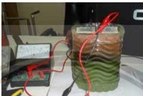
圖八：用鋅片和銅片插入蔬果泥，使用三用電表測量電壓和電流 (圖片來源：Electricity Production from Vegetative and Fruits)
